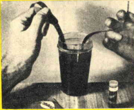
Fig. 4 - Una scena in « dissolvenza » di apertura si ottiene per via chimica, mettendo in opera l'indebolitore (di cui vi indichiamo più sotto la formula), nel quale immergeremo il film nel punto che interessa.
